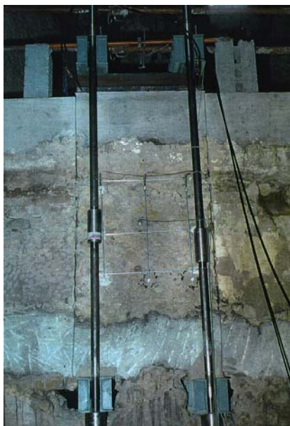
Fig. 3a - Esempio di prova a compressione diretta.
